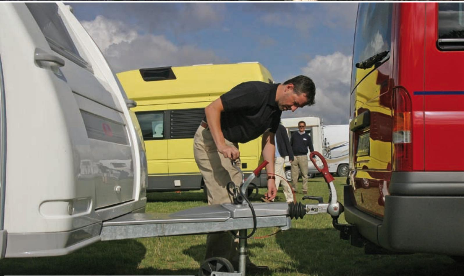
Ist der Kupplungskopf auf der Kugel eingerastet, muss das Stützrad nicht nur vollständig hochgekurbelt werden, sondern direkt unter die Deichsel gezogen und dort per Klemmschraube fixiert werden.
