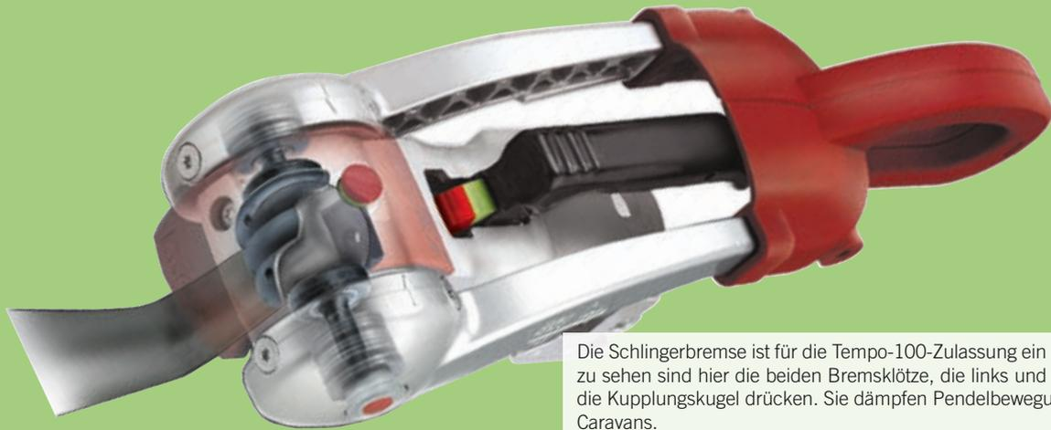
Die Schlingerbremse ist für die Tempo-100-Zulassung ein Muss. Gut zu sehen sind hier die beiden Bremsklötze, die links und rechts auf die Kupplungskugel drücken. Sie dämpfen Pendelbewegungen des Caravans.
